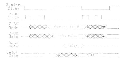
Figure 16-6. Z80 Bus Timing
